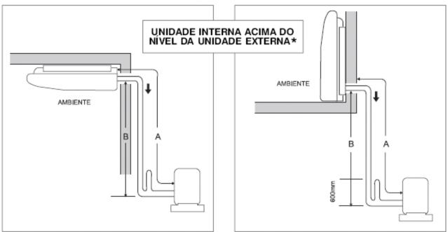
\* NESTA SITUAÇÃO, RECOMENDA SE A INSTALAÇÃO DE UM ŞIFÃO NA LINHA DE SUCÇÃO PARA PROTEÇÃO DO COMPRESSOR, AMENIZANDO EVENTUAIS GOLPES DE FLUÍDO REFRIGERANTE EM FORMA LÍQUIDA.
